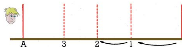
Figuur 3.25 Terugzichten: je begint bij de achterste jalon en werkt naar je toe.
